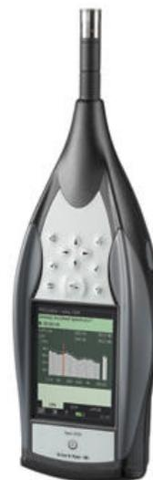
**Software di gestione in tempo reale con PC:** in tutte le configurazioni proposte, è incluso un software di gestione del 2250 (BZ 5503) attraverso un **collegamento con PC via USB o modem integrato** in uno slot del fonometro.
